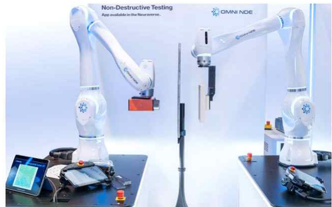
그림 14. X선 발생원과 검출기를 갖춘 두 대의 협동 로봇(코봇). X선 발생 장치와 검출기를 장착한 두 대의 협동 로봇(코봇)이 대형 복합 구조물의 컴퓨터 단층촬영 검사를 위해 레스터 스캐닝 궤적을 따라 이동한다. 출처 | Omni-NDE
