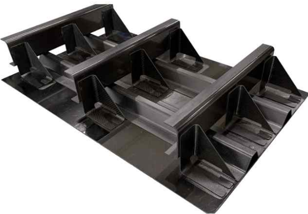
그림 19. 항공기 모형. 이 모형 항공기 구조물의 외피, 스트링거 및 프레임은 열경화성 탄소섬유강화폴리머(CFRP)로 제작되었으며, 클립은 열가소성 탄소섬유강화폴리머(CFRP) 또는 사출 성형 재료로 만들어졌다. 부품들은 열 용접으로 조립되었다(구조물 크기는 900 × 600mm). 출처(모든 이미지) | Toray공업(Toray Industries Inc.)
