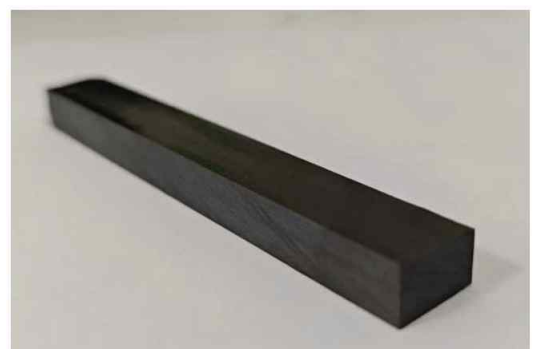
그림 8. 현장 강화 AFP를 사용한 7mm 두께의 탄소섬유/LMPAEEK 라미네이트. 출처 | 동화대학교 민간항공복합재료센터
