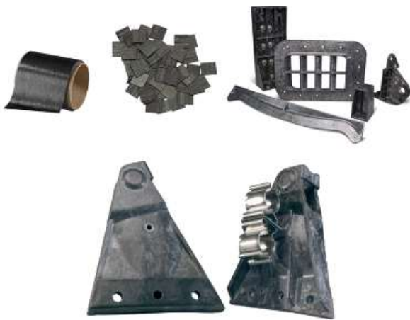
그림 18. 잘게 자른 UD 테이프로 만든 Xycomp DLF는 거의 최종 형상에 가까운 부품을 만들 수 있다. GE Unison을 위해 Greene Tweed에서 제작한 열가소성 복합재 EBU 브래킷. Xycomp DLF 소재는 잘게 자른 단방향 테이프를 압축 성형하여 거의 최종 형상에 가까운 부품(상단)으로 만들어지며, GE Unison을 위해 Greene Tweed가 탄소섬유/PEEK를 사용하여 생산한 EBU 브래킷(하단)이 그 예이다
