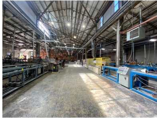
그림 4. 풀트루전 라인. PulFlex의 주요 압출 성형실은 다양한 길이와 너비의 12개 라인을 운영하고 있으며, 확장을 위한 공간도 마련되어 있다. 출처 | CW
