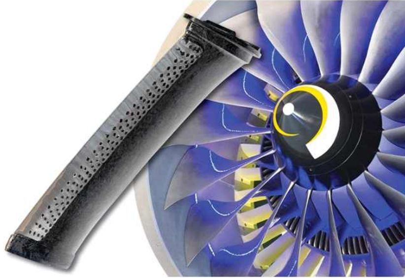
그림 22. DLR 소재로 제작된 엔진 가이드 베인(앞쪽 팬 블레이드 뒤쪽의 흰색 구조물)은 이전에는 충격 시험을 통과하기 위해 금속 코팅이 필요했다. Greene Tweed는 연속 섬유 소재와의 하이브리드 방식을 연구한 끝에, 적층 제조(AM) 기술을 적용하여 결합력을 강화한 금속 리딩 엣지를 공동 성형함으로써 코팅이 필요 없는 DLF 베인을 개발하는 데 성공했다. 출처 | Greene Tweed
