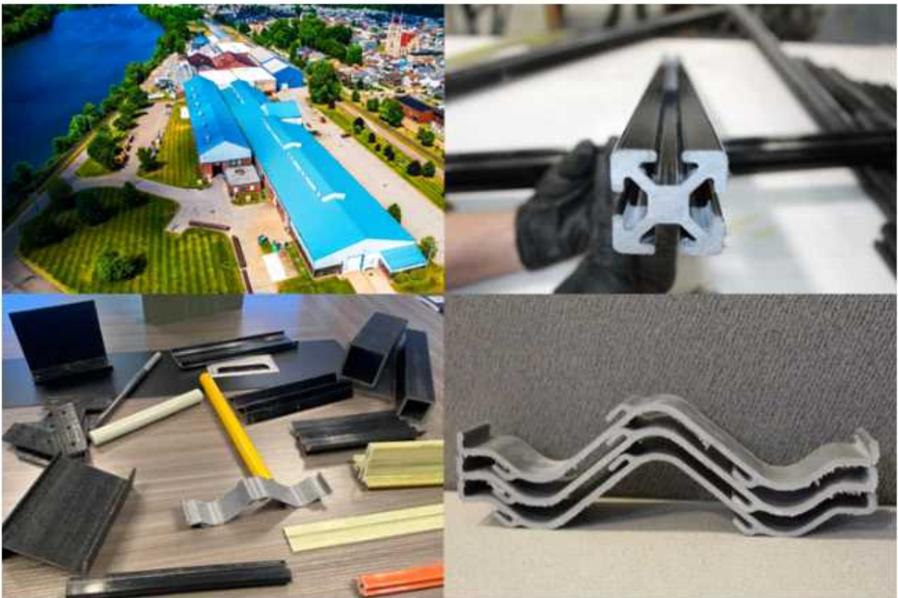
그림 9. 압출 성형 부품 모음 및 PulFlex Technologies 제조 시설 외관. PulFlex Technologies는 폴리우레탄(PUR) 기반 복합재 압출 성형을 통해 구현되는 복잡한 구조와 고성능 제품을 전문으로 한다. 이 회사는 자매 회사인 BelleFlex와 함께 피츠버그 외곽에 위치한 옛 PPG 유리 공장을 사용하고 있다. 출처 | PulFlex (상단 사진, 오른쪽 하단), CW(왼쪽 하단)
