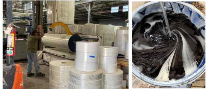
그림 2. 매트 슬리터(위), 수지 혼합물(아래). 대량의 수지 및 매트 주문은 공급업체에서 처리하지만, PulFlex는 현장에서 매트를 절단(상단)하고, 성능 및 미적 목표를 달성하기 위해 다양한 색상과 첨가제를 사용하여 맞춤형 수지를 혼합할 수도 있다(하단). 출처 | CW(상단) 및 PulFlex(하단)
