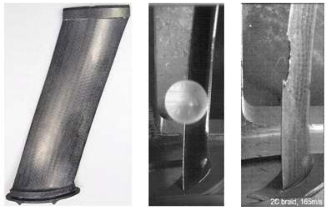
그림 19. 하이브리드 블레이드/DLF 베인 및 충격 시험 손상. DLF 코어 위에 연속 섬유 블레이드를 성형한 하이브리드 가이드 베인에 대한 시험은 충격 테스트를 통과하지 못했으며, 165m/s의 속도로 1.5인치 직경의 우박이 충돌했을 때 앞쪽 가장자리가 파손되는 현상이 나타났다.
