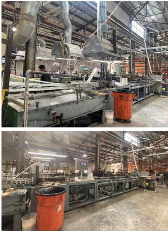
그림 5. 직접 사출 폴트루전 라인(위) & 전통적인 폴트루전 라인(아래). PulFlex의 대부분의 압출 성형 라인은 회사의 대표적인 직접 주입 PUR 기술(하단)을 사용하지만, 고객 요구에 따라 PE, VE 및 기타 수지용 기존 수지조(상단)도 사용할 수 있다. 출처 | CW
