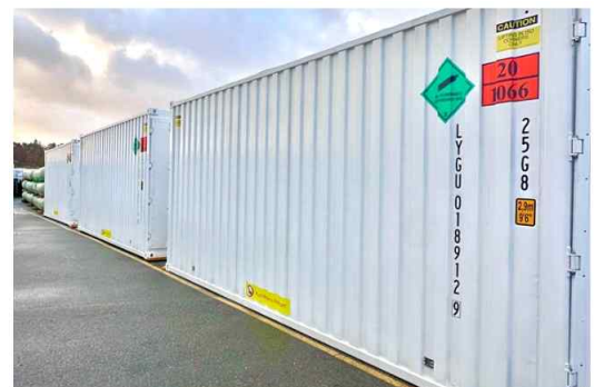
그림 39. 크리스티안산드에 위치한 Umoe Advanced Composite 사업장에 설치된 20 피트 H 2 저장 컨테이너. 출처 | UAC
