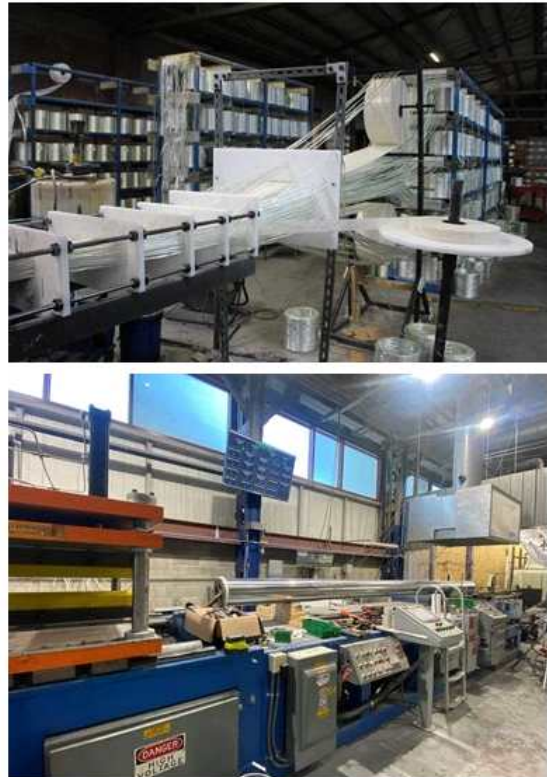
그림 6. 유리섬유 롤이 압출 성형 라인으로 끌어올려지고 있다. 이 회사가 현재까지 고객에게 공급한 가장 긴 부품은 60피트(약 18미터) 길이의 전봇대이다. 각 전봇대(아래 사진)의 금형을 사용하여 제작하는 1시간 남짓한 시간에 1,800개의 유리섬유 로빙(위 사진)을 사용하여 만들어진다. 출처 | PulFlex(위) 및 CW(아래)
