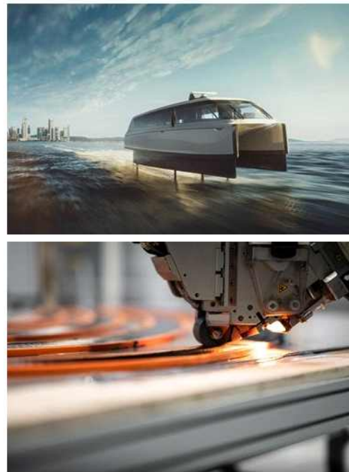
그림 38. Candela 복합재 집약형 P-12 셔틀. Avel Robotics는 AFP를 사용하여 CFRP 하이드로포일을 제작한다. 출처 | Candela(위), Avel Robotics(아래)
