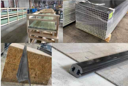
그림 1. 인발 성형 부품. CW 가 펄플렉스 공장을 방문했을 당시, 생산 라인에는 출하 준비가 완료된 부품들이 진열되어 있었다. 여기에는 창문 보강재(왼쪽 위), 차고 문 보강재(오른쪽 위), 건축 자재(오른쪽 아래), 울타리 기둥(왼쪽 아래) 등이 포함되었다. 출처 | CW
