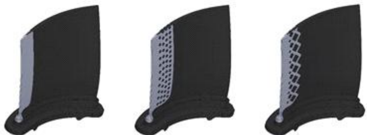
그림 21. 3D 프린팅으로 제작된 MLE 설계는 DLF 라미네이트와의 결합을 용이하게 하기 위해 시험되었다. 다양한 3D 프린팅 MLE 디자인을 시험해 보았는데, 여기에는 DLF 라미네이트와의 결합을 용이하게 하는 다이아몬드형 특징도 포함되었다.
