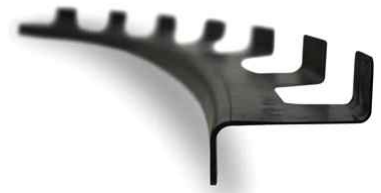
그림 6. 열가소성 단방향(UD) 테이프로 제작된 Z형 동체 프레임의 웨브를 가로지르는 플라이 수의 감소. 웨브를 가로지르는 플라이 수가 50% 감소하므로 플라이 수의 감소 위치와 툴링 상의 블랭크 위치를 매우 정확하게 조정해야 한다. 출처 | Spirit AeroSystems/ATC Manufacturing
