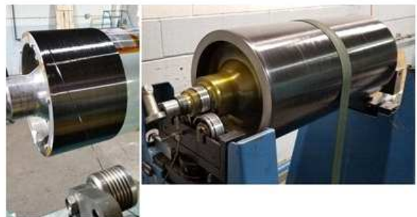
그림 11. 대구경 PMM 로터의 초고전압 필라멘트 와인딩. 대구경 PMM 로터의 초고전압 권선 (왼쪽) 및 후속 동적 밸런싱(오른쪽).
