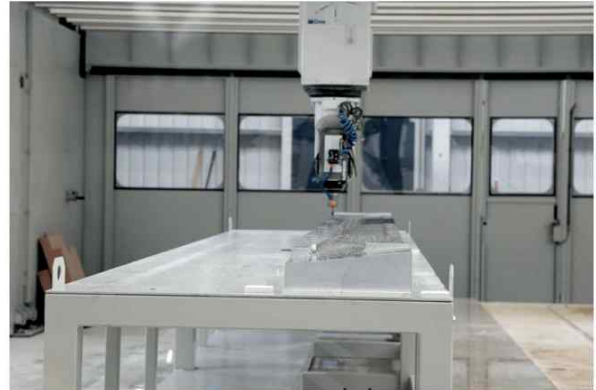
그림 4. 로터 블레이드 가공. 로터 블레이드 금형은 통 알루미늄을 가공하여 제작되며, 견고한 핸들링 프레임에 장착된 상부 및 하부 반쪽으로 조립하기 전에 여러 부분으로 나누어 사내에서 제작된다.
