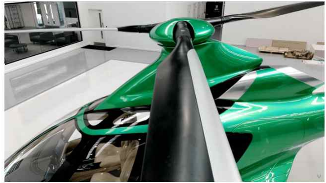
그림 6. Hill Helicopters 로터 블레이드가 녹색이다. Hill Helicopters의 주 로터 블레이드는 CFRP, GFRP, 단방향 및 이축 소재가 복합적으로 결합되어 단일 공정으로 경화된다. 출처 | Hill Helicopters
