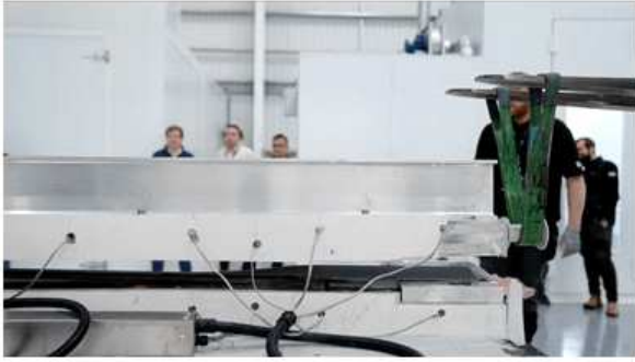
그림 5. 첫 번째 주 로터 블레이드가 분리되고 있다. HX50 메인 로터 블레이드 첫 번째 블레이드가 금형에서 분리되고 있다.
