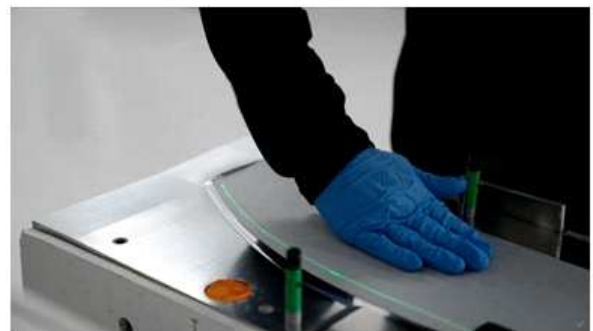
그림 2. 로터 블레이드 플라이 배치. 천장 레이저 위치 지정 시스템의 안내에 따라 CFRP 첫 번째 층이 금형에 배치된다.
