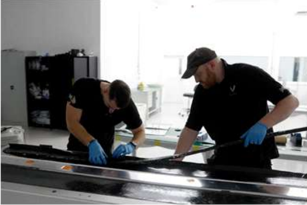
그림 3. 맨드릴에 플라이를 배치한다. 메인 스파 프리프레그 플라이가 맨드릴에 감겨 있다.
