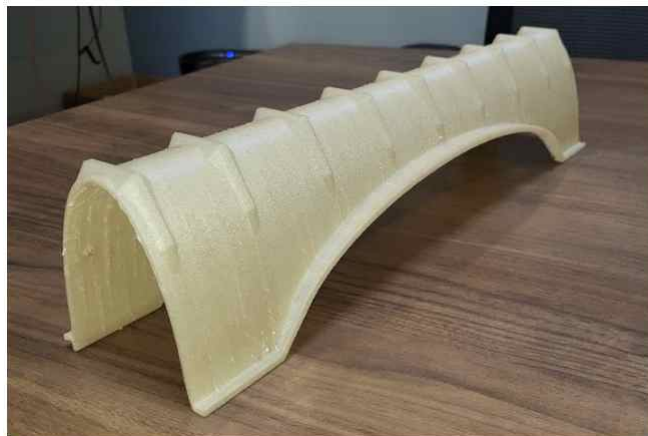
그림 20. ConTech의 기능을 보여주는 17.25(길이) × 3.75(너비) × 4(높이) 인치 크기의 축소 모형이 PETG 소재와 30% 재활용 풍력 터빈 블레이드 소재를 사용하여 출력되었다. 출처 | 메인 대학교
