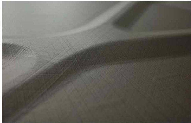
그림 22. IFW에서 AFP를 사용하여 제작한 코어 복합 샌드위치 구조. 출처 | IFW, phi 매거진
