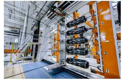
그림 2. 탄소섬유 다발은 크릴에서 공급되어 장력 조절기와 수지 욕조를 거친 후 5개의 스펀들이 있는 자동 필라멘트 와인딩 스테이션으로 이동
