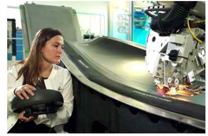
그림 10. Joby Aviation 공장 견학, 코리올리스 자동 섬유 배치 시스템을 이용한 날개 외피 제작 과정
