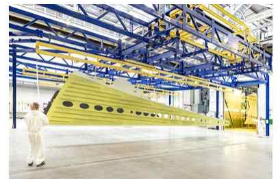
그림 4. A220 복합재 날개. 알루미늄 리브를 제외하고 A220 날개 구조의 대부분은 벨파스트에서 복합재로 제작
