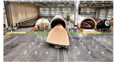
그림 3. 진공 백으로 성형된 날개 하부 커버 툴과 프리폼을 밝은 색으로 칠해진 두 개의 오토클레이브
