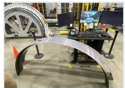
그림 1. 스탬프 성형 및 용착 접합된 열가소성 중공 캡 보강재가 외피에 일정한 곡률 반경을 가진 스킨에 용접 및 외피에는 낙뢰 보호(LSP) 기능
