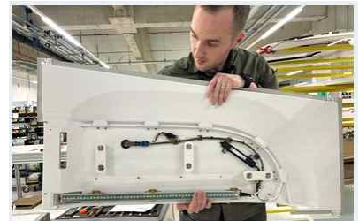
그림 5. 최종 조립 후 더욱 복잡해진 부품은 이러한 부분의 자동화가 왜 어려운지를 보여주지만, 미래에는 협동 로봇이 기술자와 함께 작업하는 방식이 도입될 수도 있음을 시사
