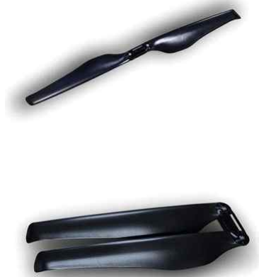
그림 17. 복합소재 드론 프로펠러 개방형. 이 회사는 금속 가공 및 복합재 제조라는 두 가지 역량을 바탕으로 멀티콥터 드론용 접이식 프로펠러의 티타늄 허브와 블레이드를 모두 제조할 수 있다.
