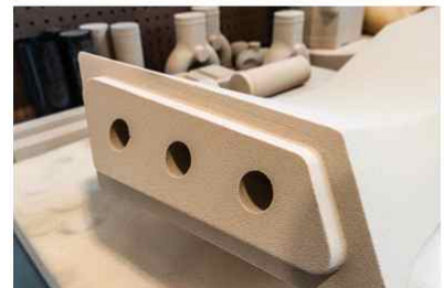
그림 16. ExOne 바인더젯 3D 프린터. Origen의 ExOne S-Print 장비는 복합재 부품용 세척 툴링 또는 확장 코어를 출력하는데 사용된다.
