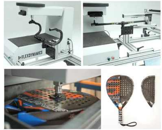
그림 18. 자전거 핸들바의 플렉스다이나믹스 테스트. 라켓에 대한 Flexdynamics 테스트. Flexdynamics 장비는 다양한 제품, 재료 및 특성을 테스트할 수 있도록 개조되었다.
