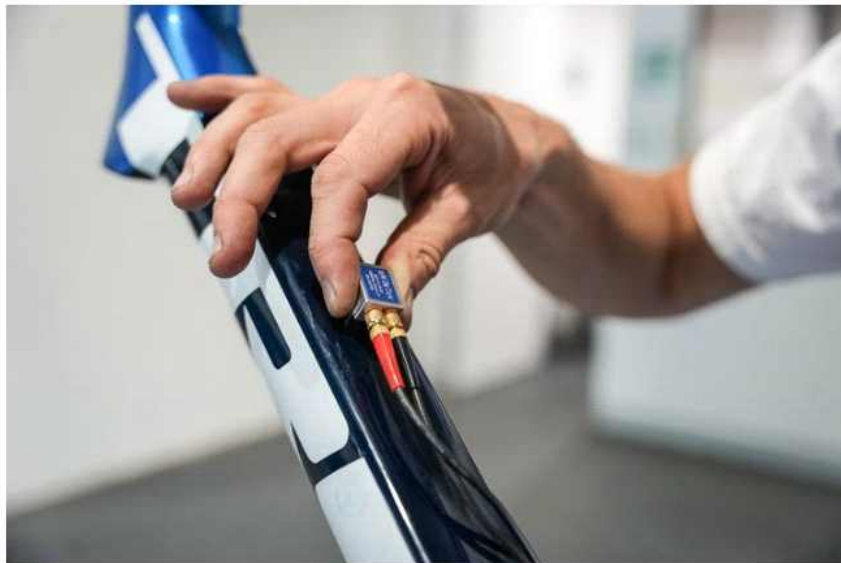
그림 7. 복합재 프레임 표면의 손상 여부를 확인하기 위해 초음파 탐침을 사용한다. 복합소재 프레임 표면의 손상 여부를 초음파 탐침으로 검사한다. 출처 | Cycle Inspect
