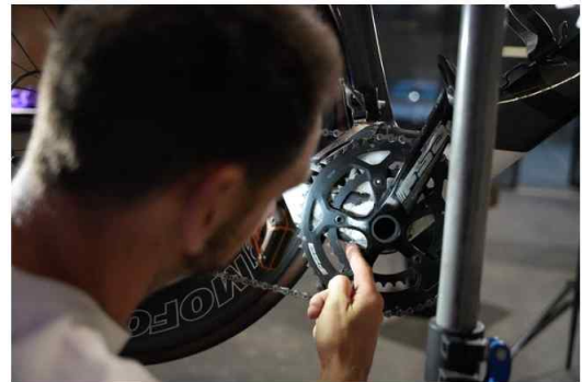
그림 3. 초음파 검사에 앞서 복합 프레임에 대한 육안 검사가 진행되고 있다. 초음파 검사에 앞서 복합 프레임에 대한 육안 검사가 진행된다.
