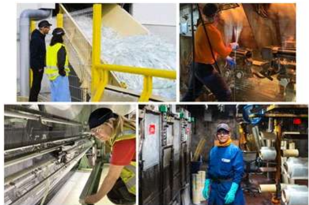
그림 24. Owens Corning은 전 세계 생산 시설에서 유리섬유 강화 제품을 제조한다. 프랑스 라르두아즈 공장의 새로운 순환 생산 라인에서는 고객으로부터 나온 건조 유리섬유 폐기물 (왼쪽 상단, 시계 방향) 이 사용된다. 이는 미국 텍사스주 아마릴로의 어드밴텍스 싱글 엔드 로빙 맞춤형 사이즈 가공부터 벨기에 젤레의 다축 섬유 생산에 이르기까지 유리섬유 제품 발전을 위해 열정적으로 노력하는 글로벌 팀의 사례 중 하나이다.
