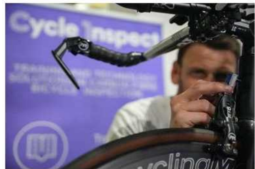
그림 4. 기술자가 장착된 복합 프레임에 초음파 검사를 실시하고 있다.
