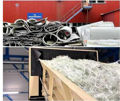
그림 25. Gjenkraft 는 수명이 다한 풍력 터빈 블레이드에서 유리섬유를 재활용한다. Gjenkraft는 수명이 다한 풍력 터빈 블레이드에서 유리섬유를 재활용하고 있다. 출처 | Gjenkraft
