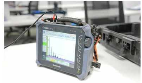
그림 5. 초음파 스캐너가 A-스캔 파형을 표시하는 모습. 초음파 스캐너는 지하 이상 징후를 나타내는 A-스캔 파형을 표시한다.
