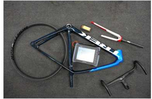
그림 2. 복합소재로 만들어진 자전거 프레임과 기타 부품들이 땅에 놓여 있다. 복합소재로 만들어진 자전거 프레임, 바퀴, 포크 및 핸들바는 오늘날 자전거에서 흔히 볼 수 있는 복합소재 구조의 예이다.
