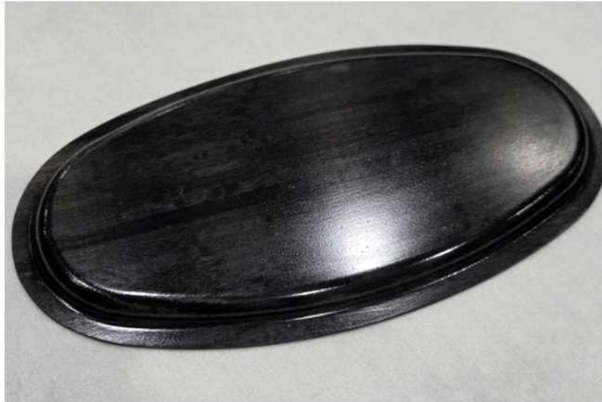
그림 5. 재활용 프리프레그 소재로 제작된 항공기 접근 패널 시연 장치. 출처 | NCC
