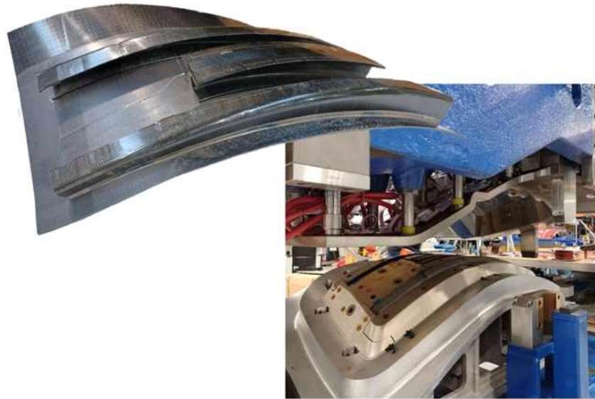
그림 17. HPRTM을 위한 시연용 부품 및 혁신적인 툴링. 출처 | Airbus, SAUBER 4.0 프로젝트
